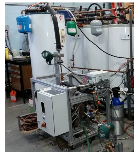
Figure 6. Prototype de thermopompe au \text{CO}_2 en mode transcritique à l'essai à l'Université Queen's.
