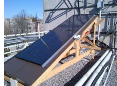
Figure 5. Photo de capteurs PVT sur une simulation de toit et résumé des résultats des expériences
